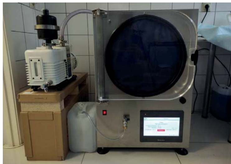
Рисунок 4. Лيوфилизатор мобильного камерного типа «Лиомед®» (фотография авторов)
